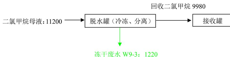
图 3.2.2.1-5 二氯甲烷母液回收物料平衡图（单位：kg/d 18h/d×150d/a）
